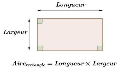
$$\text{Aire}_{\text{rectangle}} = \text{Longueur} \times \text{Largeur}$$
